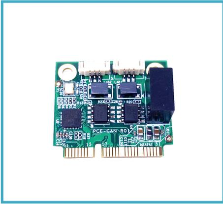
高性能Mini-PcieCAN卡，可以将带Mini-Pcie卡槽的主板扩展出两路CAN接口，采用标准的Mini-Pcie半高/全高板卡尺寸，方便安装在带有mini-pcie卡槽的设备上使用。
